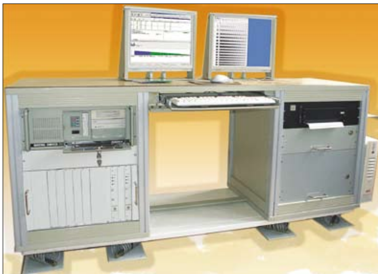
БОРТОВОЙ КОМПЛЕКС СЕЙСМОСТАНЦИИ ПРОГРЕСС – Т2 НА 4800 АКТИВНЫХ КАНАЛОВ В РЕАЛЬНОМ ВРЕМЕНИ
