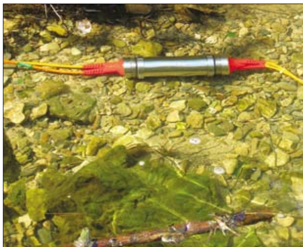
БЛОК СБОРА ДАННЫХ БСД-1 СЕЙСМОСТАНЦИИ ПРОГРЕСС – Т155, МАКСИМАЛЬНАЯ ГЛУБИНА ПОГРУЖЕНИЯ – 25 М
