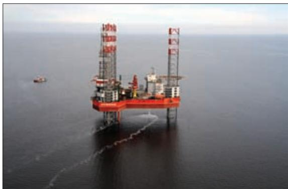
САМОПОДЪЕМНАЯ ПЛАВУЧАЯ БУРОВАЯ УСТАНОВКА
