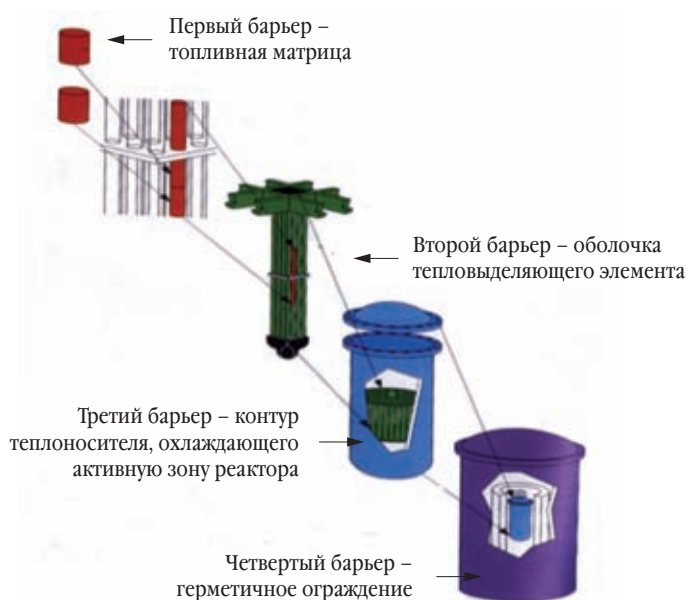
СИСТЕМА ФИЗИЧЕСКИХ БАРЬЕРОВ НА АТОМНОЙ СТАНЦИИ
