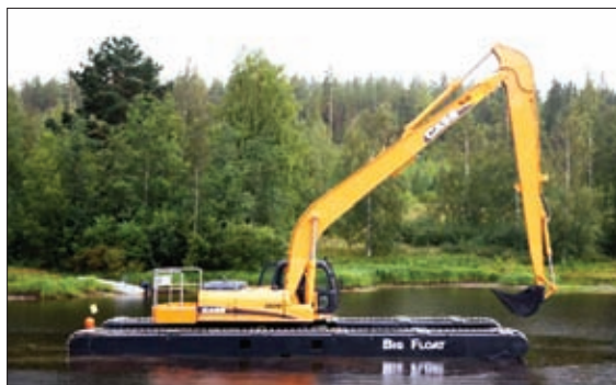
ВОДНЫЙ ЭКСКАВАТОР ДЛЯ ГЛУБОКОВОДНОГО РЫТЬЯ ТРЕНШЕЙ И УДАЛЕНИЯ ТВЕРДОТЕЛЬНЫХ ПРЕПЯТСТВИЙ:
