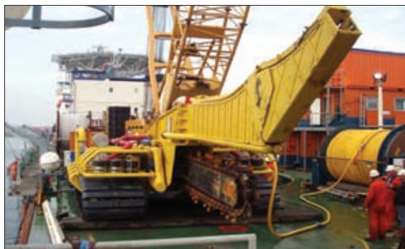
ПОДВОДНЫЙ ТРЕНШЕКОПАТЕЛЬ С СИЛОВЫМИ СИСТЕМАМИ И СИСТЕМАМИ ДИСТАНЦИОННОГО УПРАВЛЕНИЯ
