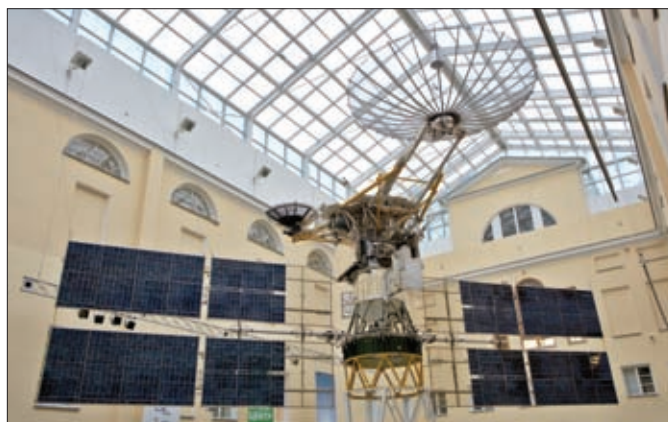
СПУТНИК-РЕТРАНСЛЯТОР «ЛУЧ-15». МАССА НА ОРБИТЕ – 2410 КГ. РЕСУРС НА ОРБИТЕ – 5 ЛЕТ. МОЩНОСТЬ СИСТЕМЫ ЭЛЕКТРОПИТАНИЯ – 2660 Вт. НПО ПРИКЛАДНОЙ МЕХАНИКИ ИМЕНИ АКАДЕМИКА М.Ф. РЕШЕТНЕВА, РОССИЙСКИЙ НИИ КОСМИЧЕСКОГО ПРИБОРОСТРОЕНИЯ
