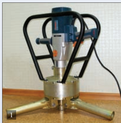
1. ЭЛЕКТРОМАШИНА (ЭЛЕКТРОМЕХАНИЗМ) ДЛЯ ЗАВИНЧИВАНИЯ ВИНТОВЫХ СВАЙ R205-75
