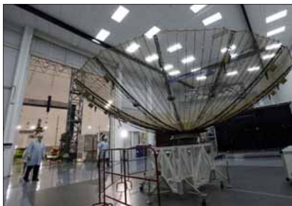
ТРАНСФОРМИРУЕМЫЙ РЕФЛЕКТОР (Ø 4 м) ПЕРЕНАЦЕЛИВАЕМОЙ АНТЕННЫ КА «ЛУЧ-5А/Б/В»
