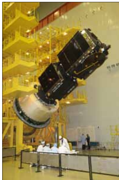
КОСМИЧЕСКИЕ АППАРАТЫ «ЭКСПРЕСС-АТ1» И «ЭКСПРЕСС-АТ2». ТАНДЕМНАЯ СХЕМА ВЫВЕДЕНИЯ
