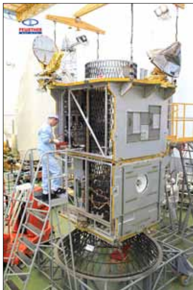
КОСМИЧЕСКИЙ АППАРАТ «ЛУЧ-5Б». СТЫКОВКА ПОЛЕЗНОЙ НАГРУЗКИ И ПЛАТФОРМЫ
