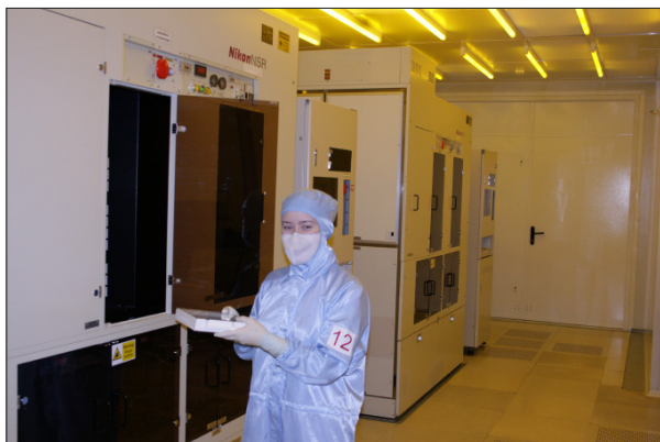
УСТАНОВКА НАНЕСЕНИЯ И ПРОЯВЛЕНИЯ ФОТОРЕЗИСТА
