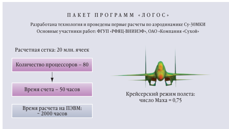
РАСЧЕТ АЭРОДИНАМИЧЕСКИХ ХАРАКТЕРИСТИК БОЕВОГО РЕАКТИВНОГО САМОЛЕТА СУ-30МКИ
