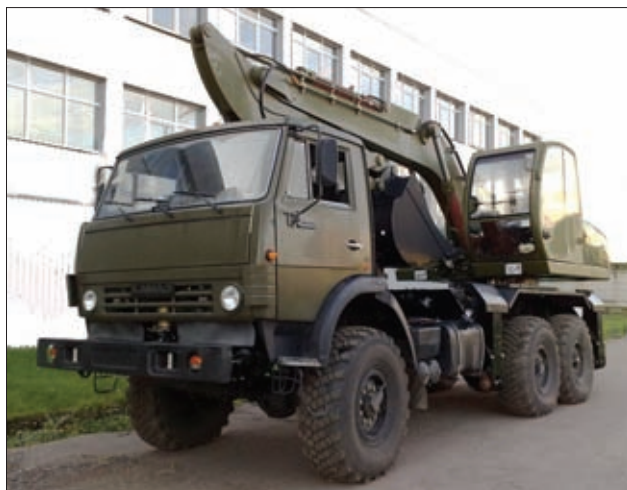
8. Экскаватор одноковшовый войсковой ЭОВ-3523
