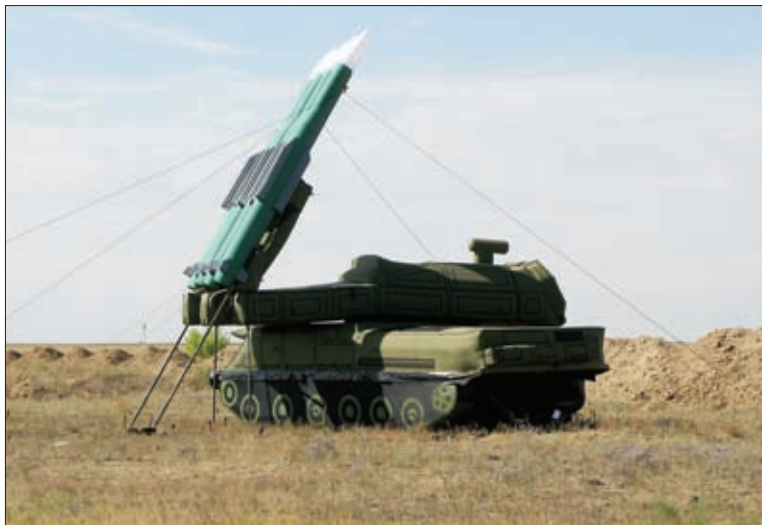
18. Маскировочный комплект МКТ-4Л 19, 20. Пневмоподпорные макеты ВВСТ
