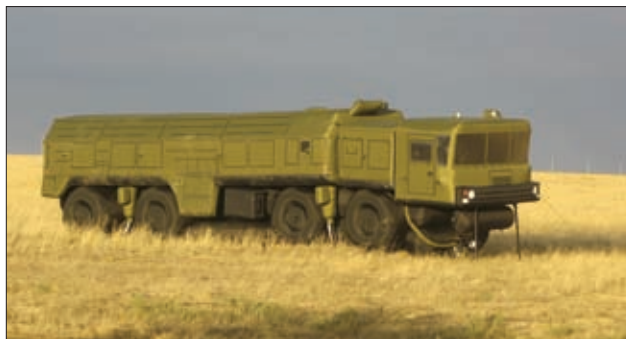
18. Маскировочный комплект МКТ-4Л 19, 20. Пневмоподпорные макеты ВВСТ
