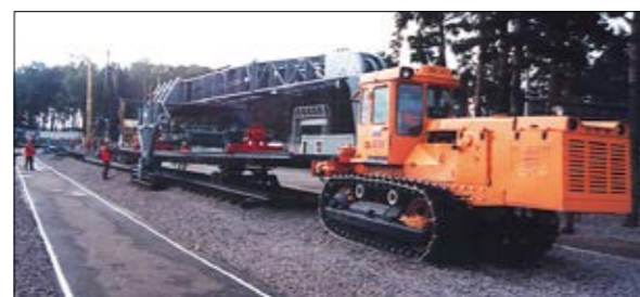
Рис. 3. Погрузчик фронтальный на комбинированном ходу из состава комплекса путевого универсального.
