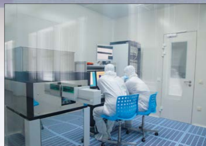
Установка автоматического контроля топологии фотошаблонов на соответствие проектным данным.
