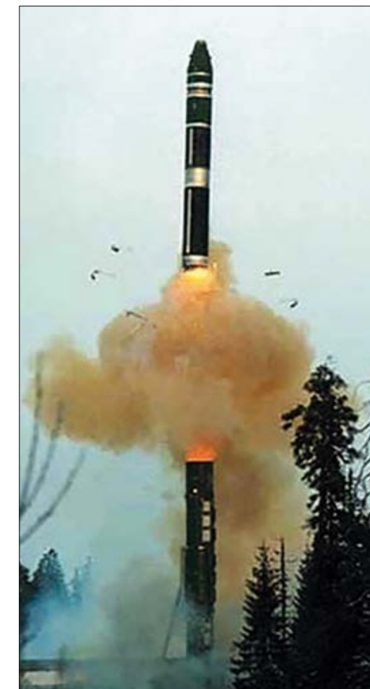
5. Минометный старт ракеты РТ-23 из пускового модуля БЖРК.
