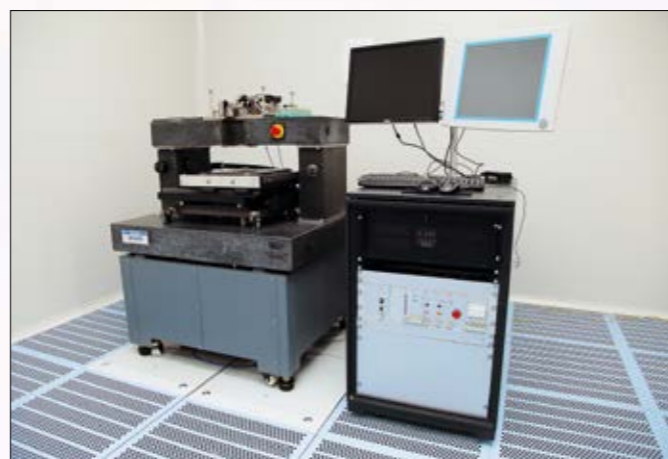
Установка контроля критических размеров.
