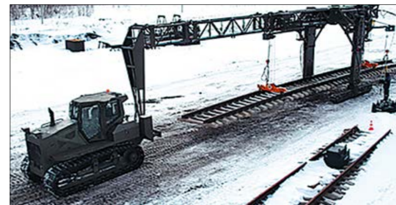
Рис. 6. Проведение государственных испытаний опытного образца путеукладчика тракторного ПБ-5.
