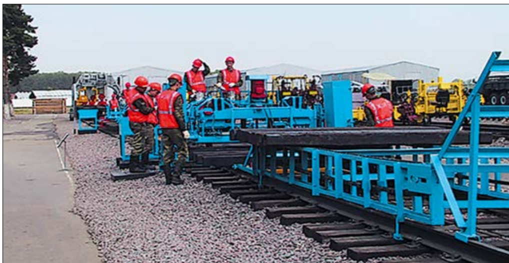
Рис. 7. Общий вид звеноборочного станда ЗС-400.
