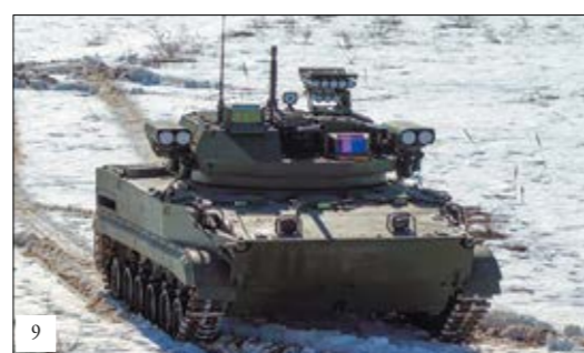
Рис. 7. БМП-2 с боевым отделением «Бережок». Рис. 8. БМПТ. Рис. 9. БМП Б-19 с боевым модулем «Эпоха».
