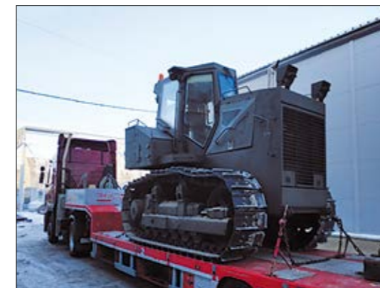
Рис. 5. Сборка прицепной части и базового тягача опытного образца портального путеукладчика ПБ-4.
