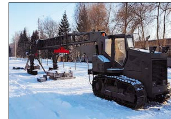
Рис. 5. Сборка прицепной части и базового тягача опытного образца портального путеукладчика ПБ-4.
