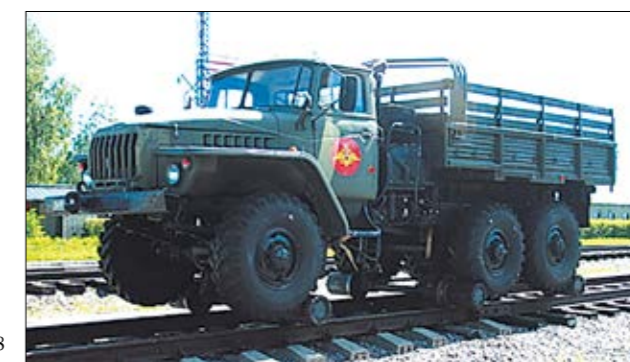
Рис. 8. Автомобиль Урал-4320 на комбинированном ходу.
