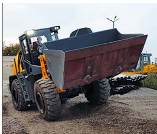
Рис. 3. Погрузчик фронтальный на комбинированном ходу из состава комплекса путевого универсального.
