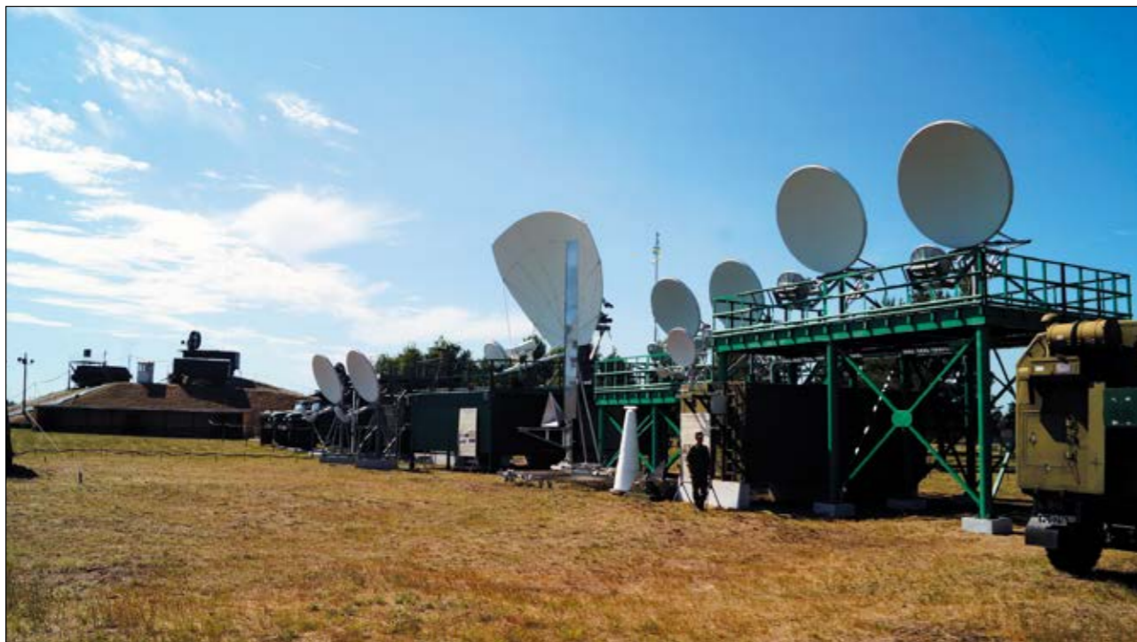
Рис. 3. Многофункциональная система измерительных радиолокационных комплексов оценки заметности объектов ВВТ. Предназначена для оценок характеристик радиолокационной заметности объектов ВВТ и построения их радиолокационных портретов.
