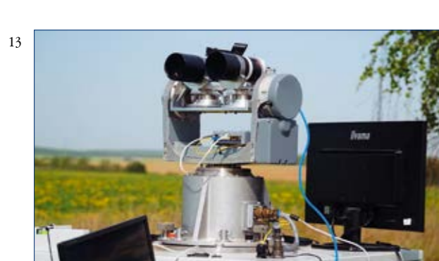
13, 14. Военно-технический эксперимент по оценке функциональных возможностей оптико-электронного комплекса разведки воздушного пространства «Обзор-1Н».
