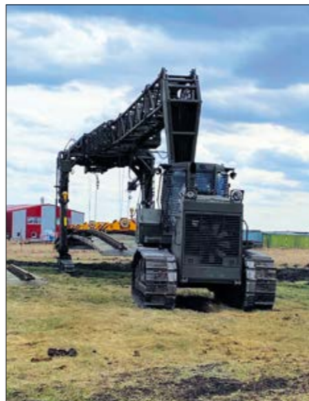
Рис. 14. Путеукладчик тракторный ПБ-5.
