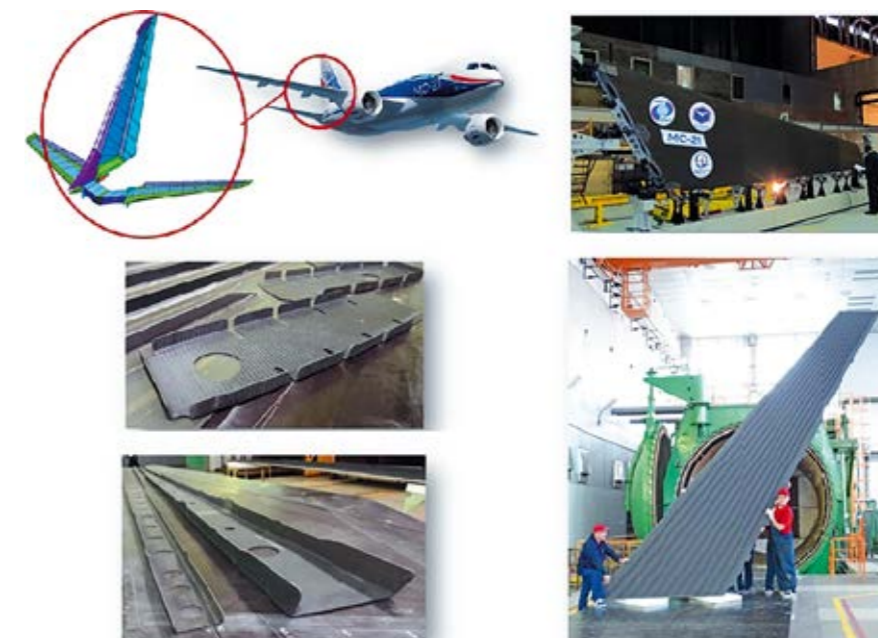
Рис. 3. Изготовление из ПКМ широкой номенклатуры элементов кессонов киля и стабилизаторов самолета МС-21
