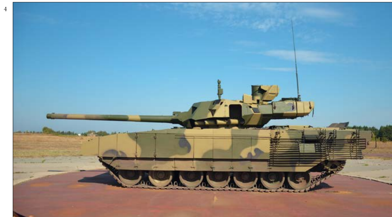
Рис. 4. Поворотная платформа большой грузоподъемности (ППБГ - 100). Применяется при построении радиолокационных изображений с различных ракурсов
