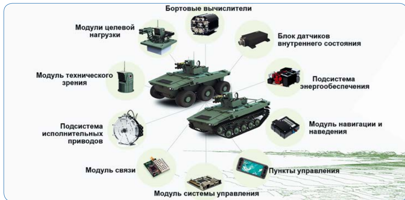
Рисунок 4. Экспериментальная робототехническая платформа на примере наземных РТК и ее базовые модули.
