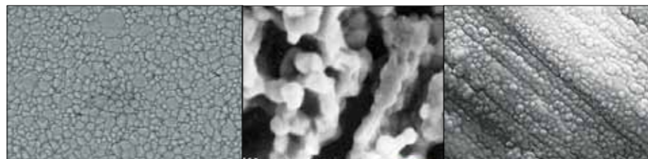
Рис. 2. Микроструктура плотной и пористой керамики (а, б), покрытие из гидроксиапатита (в)
