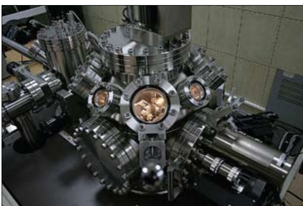
Сканирующий зондовый микроскоп с атомарным разрешением для центра ионно-плазменных и нанотехнологий
