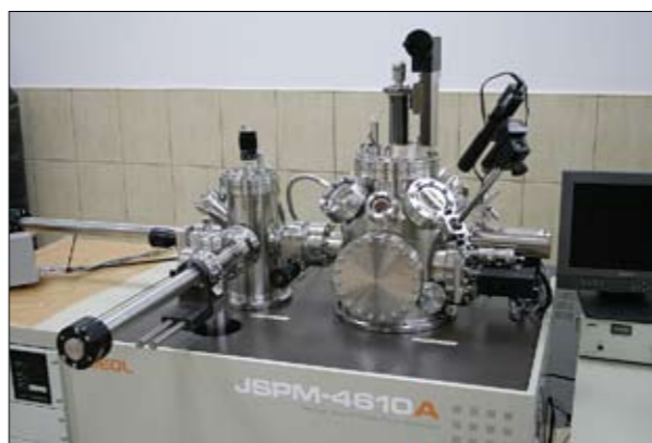
Сканирующий зондовый микроскоп с атомарным разрешением для центра ионно-плазменных и нанотехнологий
