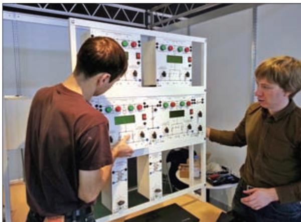
СТЕНДЫ ИМЕЮТ ГИБКУЮ МОДУЛЬНУЮ СТРУКТУРУ
