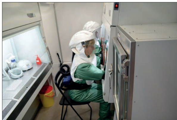
РАБОТА В БОКСЕ МИКРОБИОЛОГИЧЕСКОЙ БЕЗОПАСНОСТИ III КЛАССА ЗАЩИТЫ В ЛАБОРАТОРИИ ИНДИКАЦИИ МОБИЛЬНОГО КОМПЛЕКСА
