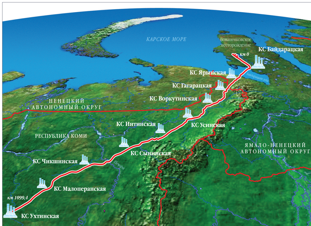
СИСТЕМА МАГИСТРАЛЬНЫХ ГАЗОПРОВОДОВ БОВАНЕНКОВО – УХТА – ТОРЖОК
