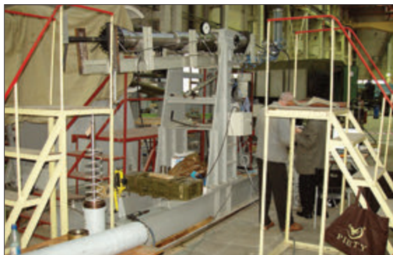
СТЕНД ОТРАБОТКИ СИСТЕМЫ ОХЛАЖДЕНИЯ СТВОЛОВ ЦНИИ «БУРЕВЕСТНИК»
