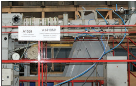
СТЕНД ОТРАБОТКИ СИСТЕМЫ ОХЛАЖДЕНИЯ СТВОЛОВ ЦНИИ «БУРЕВЕСТНИК»
