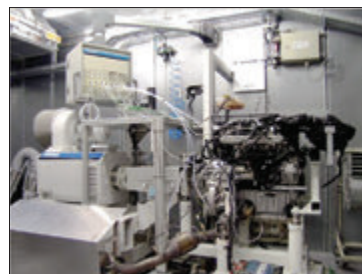
ОБОРУДОВАНИЕ ДЛЯ СТЕНДОВЫХ ИСПЫТАНИЙ ДВИГАТЕЛЕЙ ЧТЗ-УРАЛТРАКА
