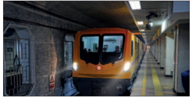
АВТОМОТРИСА RAILWAY LAB ULTRASONIC TEST TVEMA 70 ДЛЯ ДИАГНОСТИКИ ПЕКИНСКОГО МЕТРОПОЛИТЕНА
