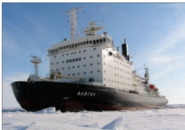
МЕЛКОСИДЯЩИЕ АТОМОХОДЫ «ВАЙГАЧ» И «ТАЙМЫР» СПОСОБНЫ ДЕЙСТВОВАТЬ В УСТЬЯХ КРУПНЫХ РЕК
