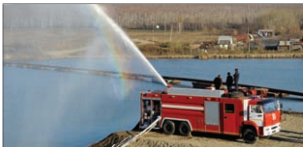
ИСПЫТАНИЕ МОЩНОЙ НАСОСНОЙ УСТАНОВКИ ПОЖАРНОГО АВТОМОБИЛЯ АЦ 10,0-150 (КАМАЗ-65225) ПРОИЗВОДСТВА ООО «УСПТК-ХОЛДИНГ»
