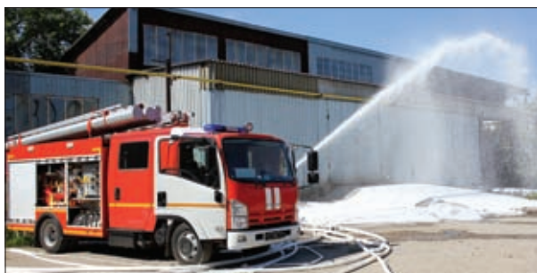
ИСПЫТАНИЕ ПОЖАРНОГО АВТОМОБИЛЯ АЦ 1,5-40/2 (ISUZU NQR90L) С УСТАНОВКОЙ КОМПРЕССИОННОЙ ПЕНЫ
