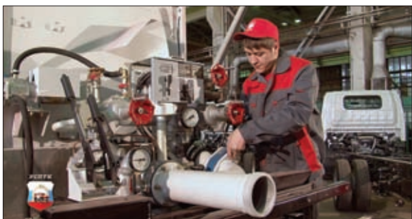
УСТАНОВКА ПОЖАРНОГО НАСОСА СОБСТВЕННОЙ РАЗРАБОТКИ
