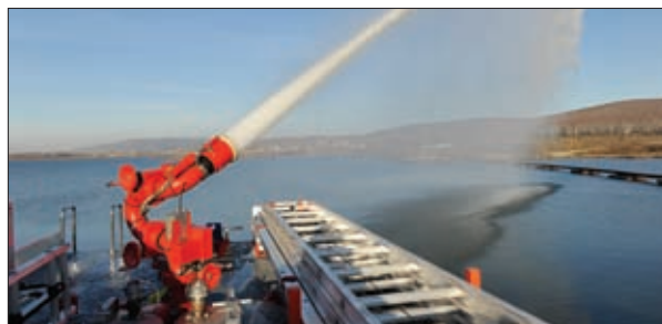
ИСПЫТАНИЕ МОЩНОЙ НАСОСНОЙ УСТАНОВКИ ПОЖАРНОГО АВТОМОБИЛЯ АЦ 10,0-150 (КАМАЗ-65225) ПРОИЗВОДСТВА ООО «УСПТК-ХОЛДИНГ»
