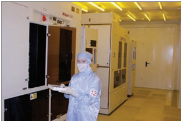
УСТАНОВКА НАНЕСЕНИЯ И ПРОЯВЛЕНИЯ ФОТОРЕЗИСТА
